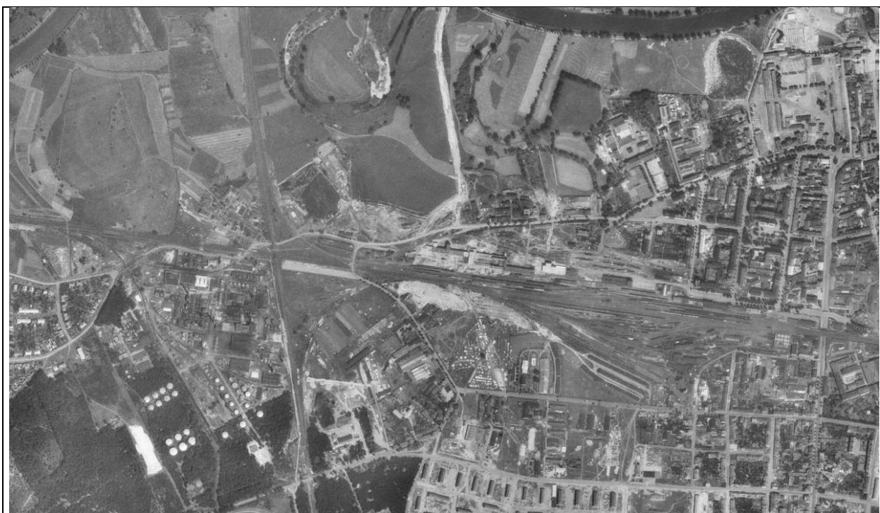
Obr. 3-1: Letecký snímek z r. 1954 – severně od kolejíště je rozestavěná výpravní budova, celé kolejíště je situováno východněji než po přestavbě a také je patrná kolejová spojka Medlešice - Pardubice (zdroj: kontaminace.cenia.cz )
